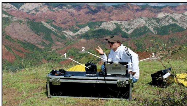
**Рисунок 2.5 - Комплекс управления БПЛА для проведения аэрофото-съемки. 1 - Пульт управления, 2 - антенна, 3 - наземная станция**
