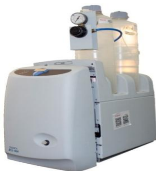
Рисунок 5.4. - Ионный хроматограф Dionex ICS-900
